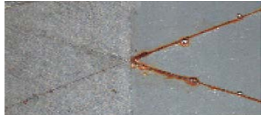
左邊塗佈 VpCI 防鏽塗料，右邊塗佈一般防鏽塗料而明顯呈現鏽蝕由刮痕處往兩側擴散蔓延。
