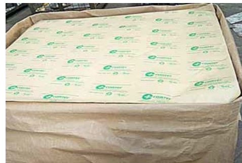
金屬零件上方平鋪一張 VpCI-146 氣化防鏽包裝紙後密封包裝
