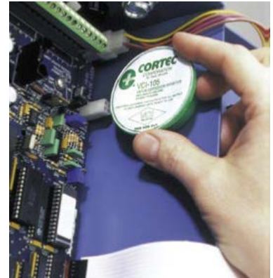
VpCI-105 放置於電控箱中
