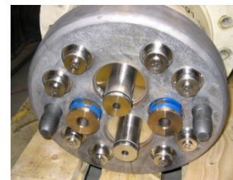
VpCI-422 除鏽完成
